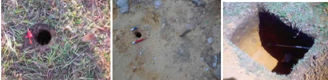
Foto 20.Extracción de muestras para los diferentes ensayos sobre el suelo
