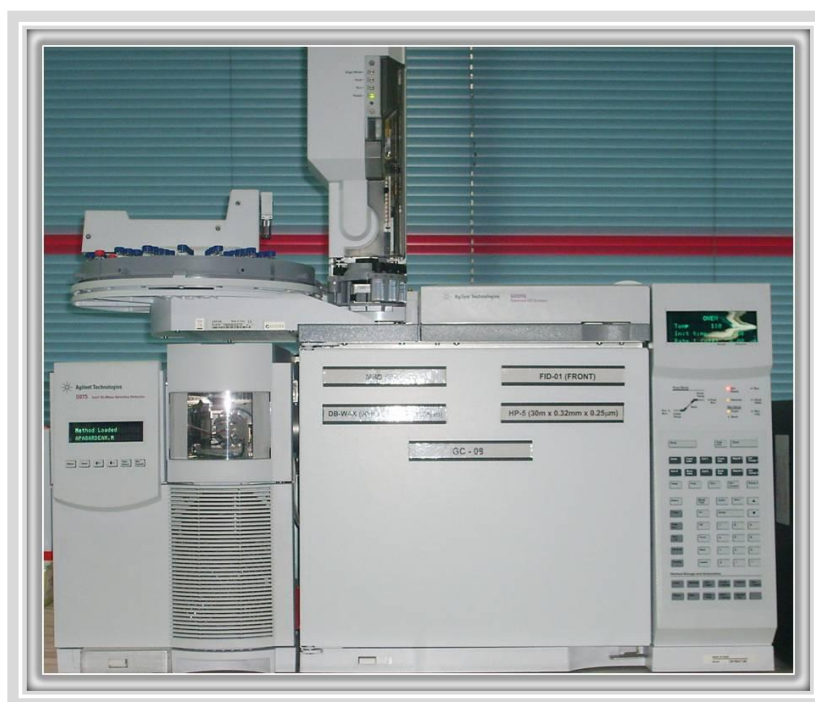
Figura 3. Cromatógrafo Agilent Technologies 6890N Network Series GC , acoplado a un espectrómetro de masas Agilent Technologies 5975 Inert XL .
