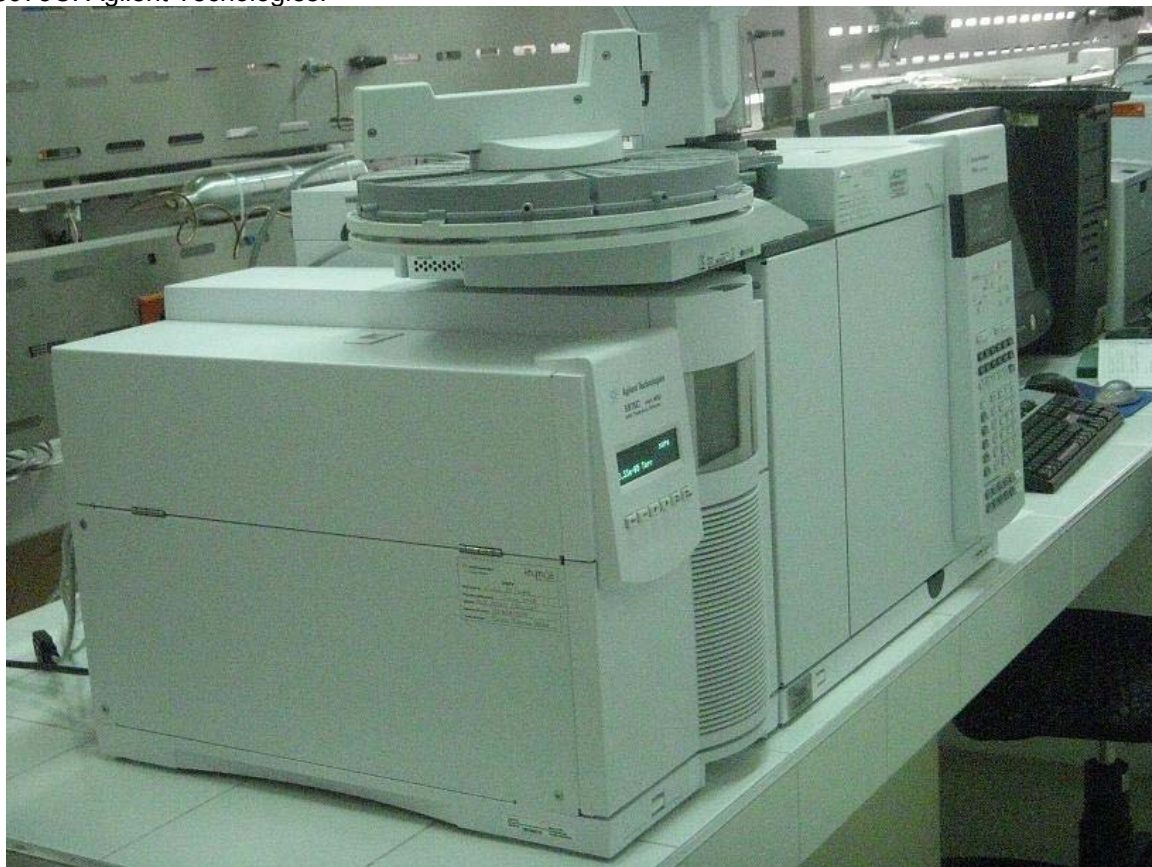
Figura 13. Cromatógrafo de Gas Acoplado a detector de masas. Referencia GC- EM 7890A – 5975C. Agilent Technologies.
