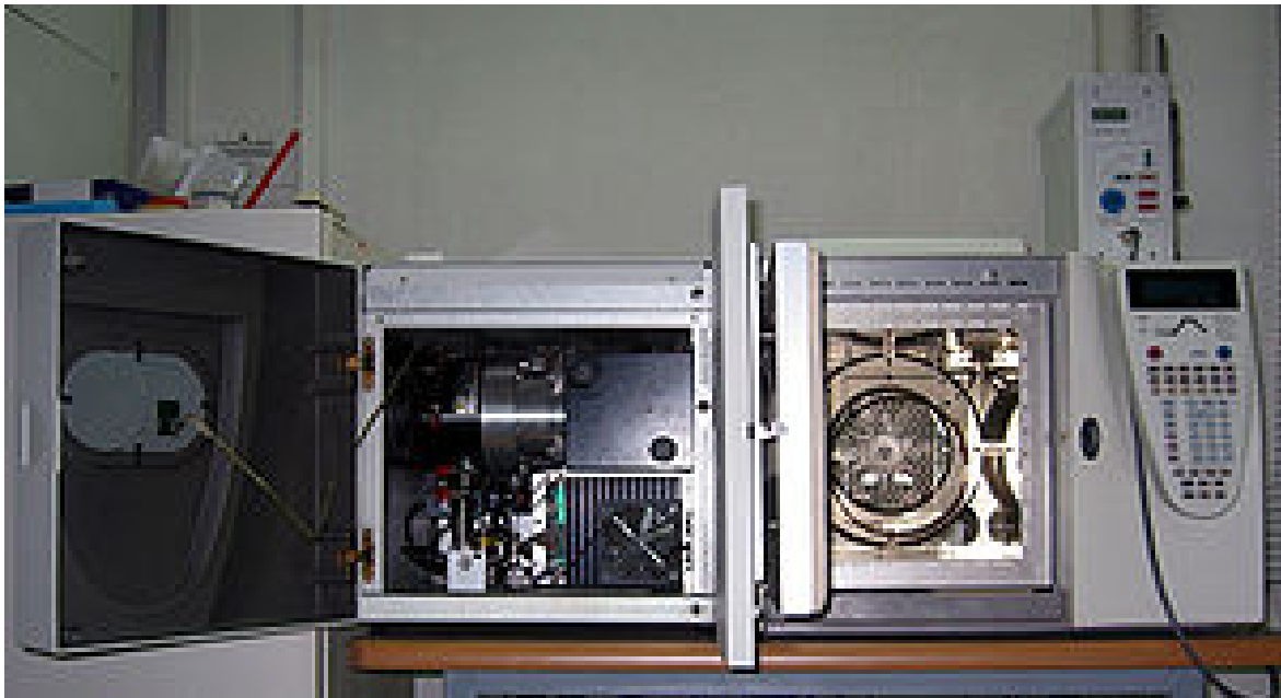
Figura 14. El interior de la GC-MS, con la columna del cromatógrafo de gases en el horno de la derecha.
