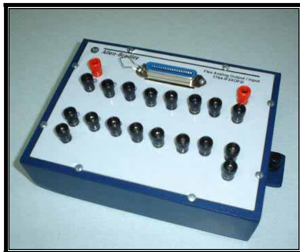
Figura 22. Módulo de integración de entradas y salidas analógicas.
