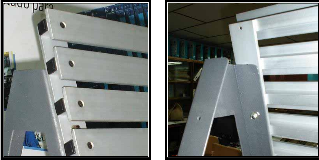
Figura 19. Detalle de sujeción del panel de montaje.
