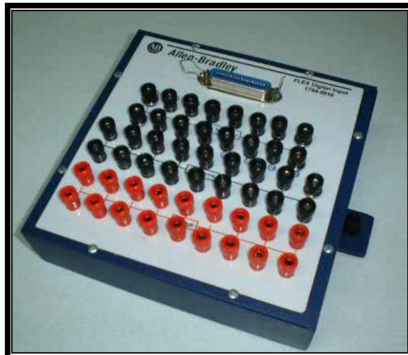
Figura 21. Módulo de integración de entradas digitales
