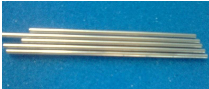
Figura 3. Condiciones de entrega de los microtubos de Nitinol.
