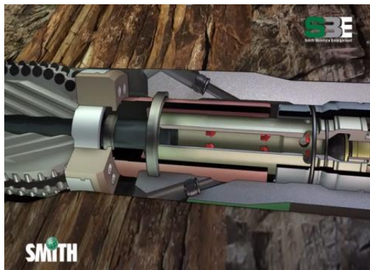
7. El contraflujo mueve el pistón y el aro de accionamiento o Drive Ring .
