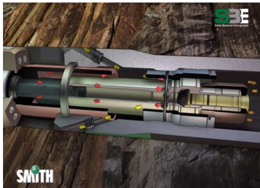
9. Parte del contraflujo sale flujo por las boquillas del Rhino XS .
