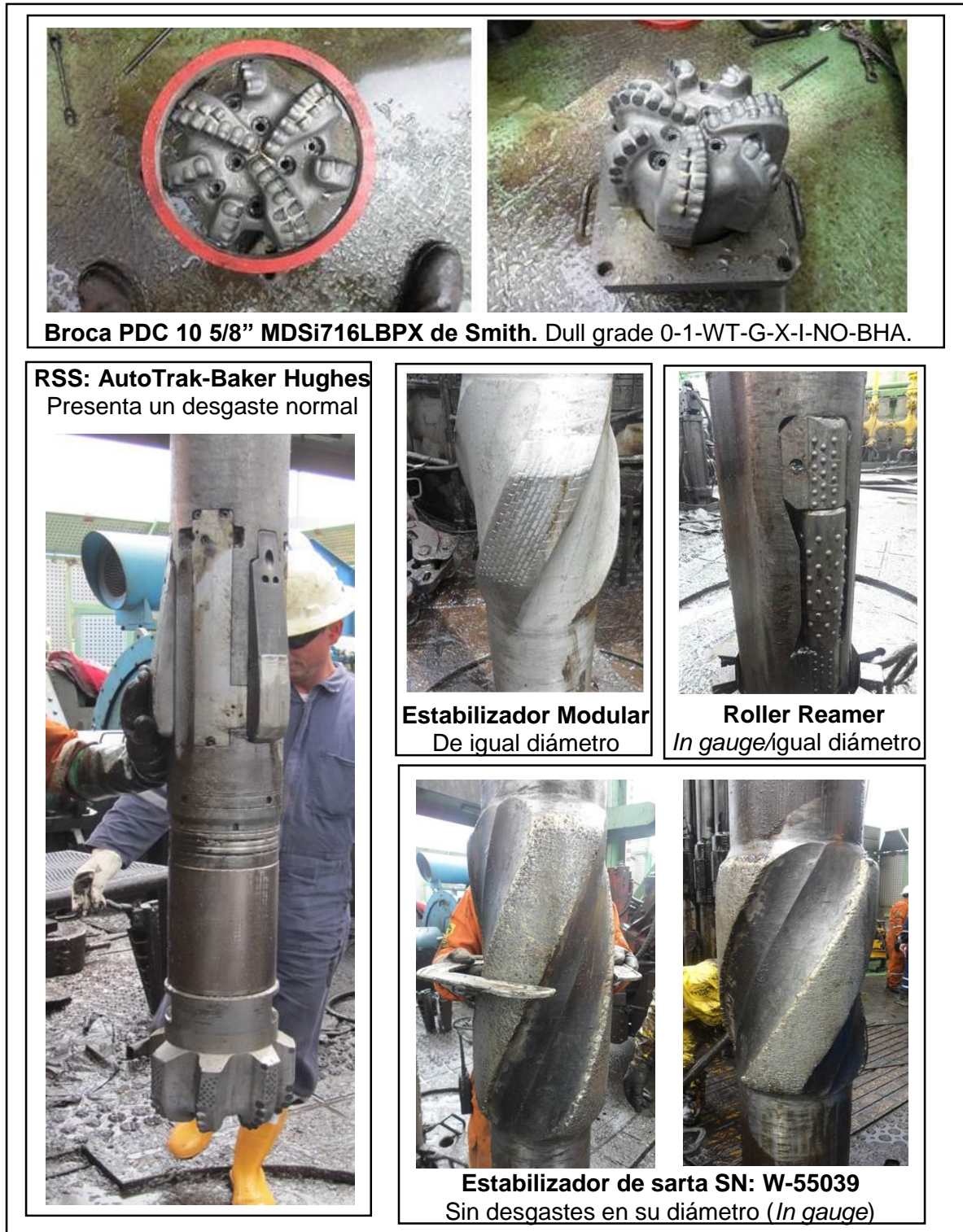
Figura 48. Salida de otros componentes del BHA con el Rhino Reamer XS
