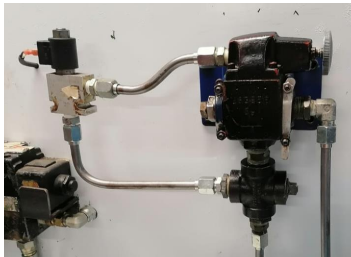
Ilustración 5 - Válvula de seguridad pilotada con venteo.
