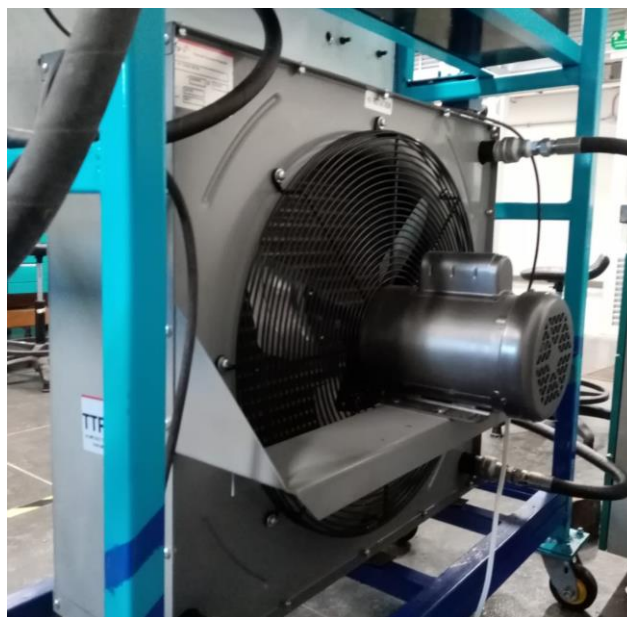
Ilustración 15 - Enfriador de aceite hidráulico.
