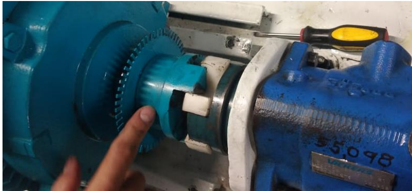
Ilustración 17 - Estado del acople producto de las vibraciones.
