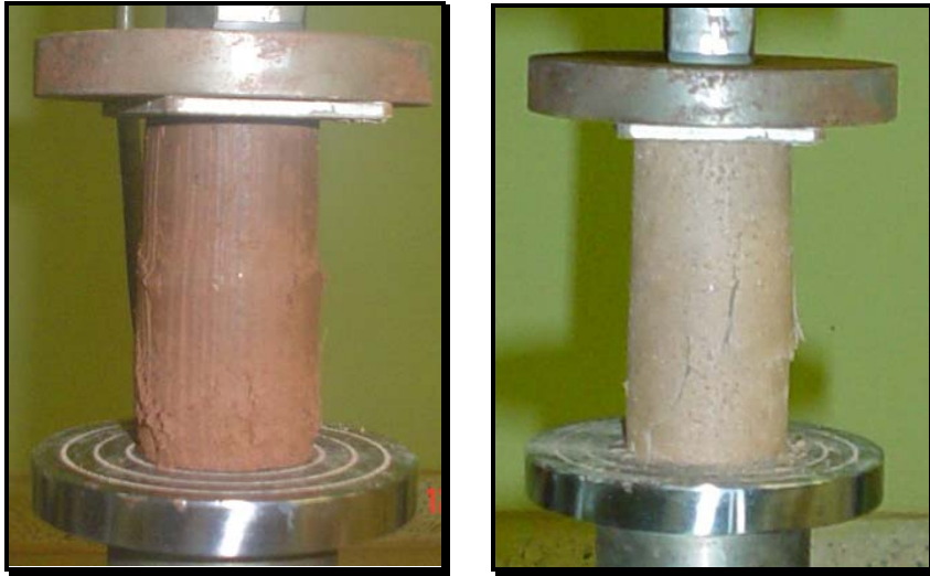
Fotografía 6. Falla característica de las probetas compresión simple
