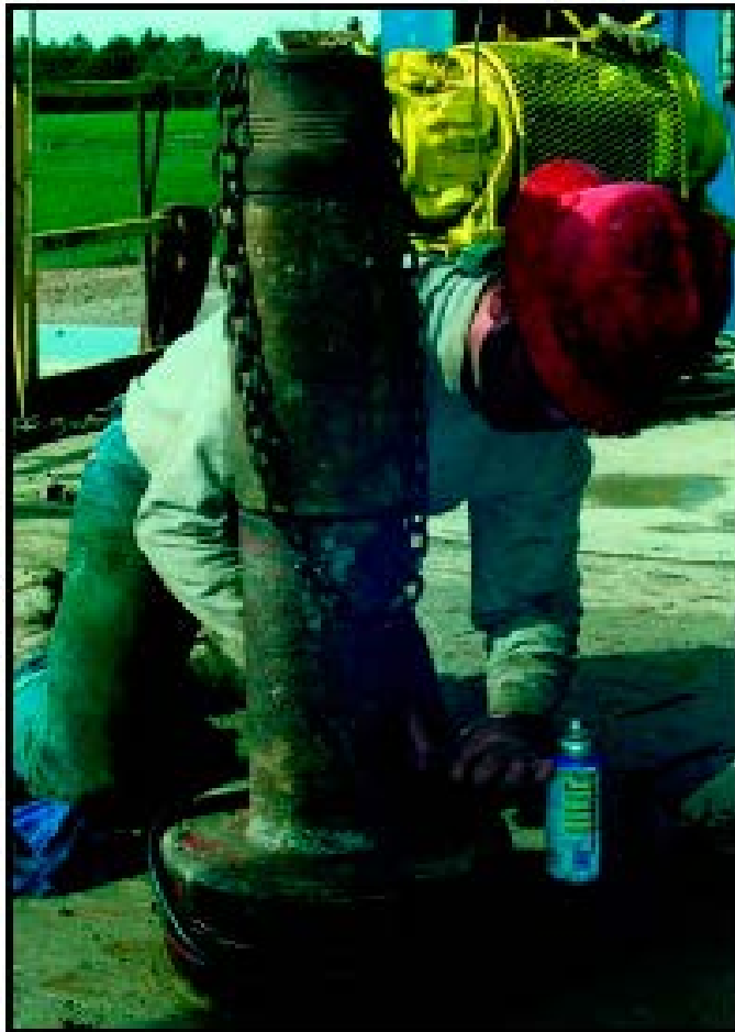
Figura 63. Herramienta para probar las preventoras de reventones
