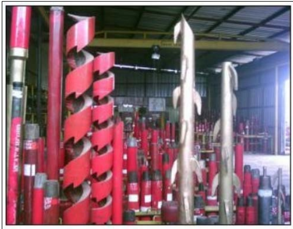
Figura 98. Herramienta para pesca de cable
