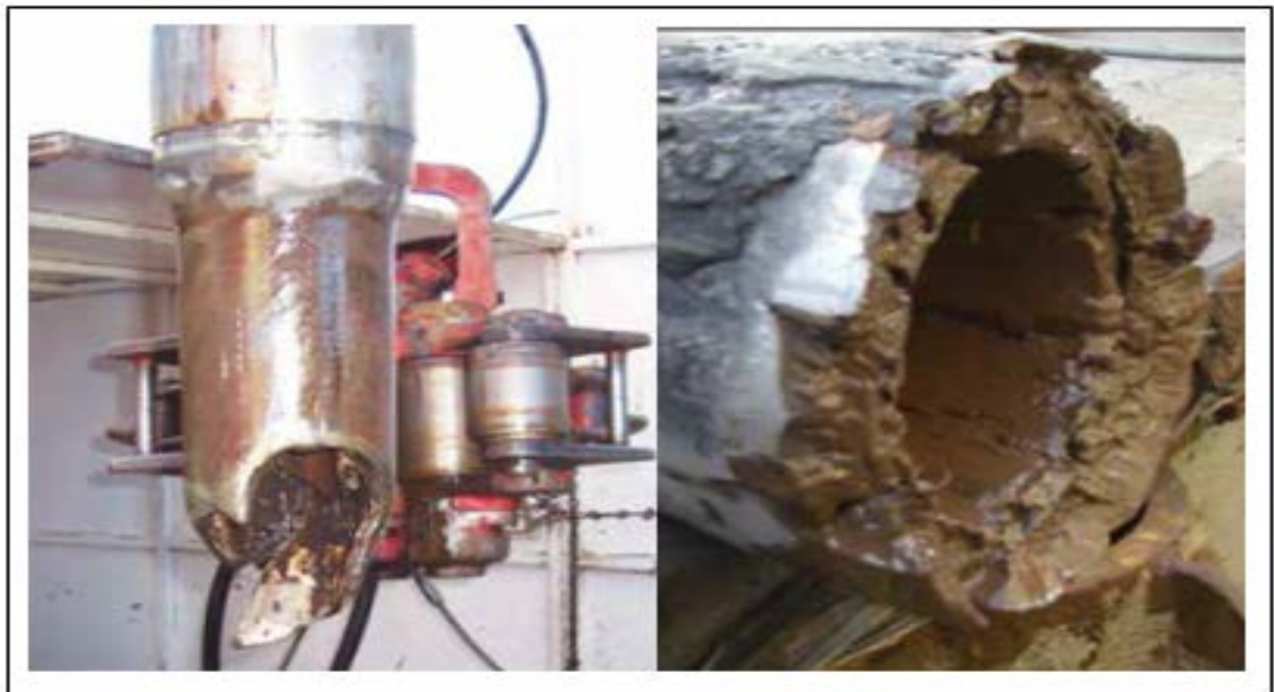
Figura 88. Falla de la sarta de perforación
