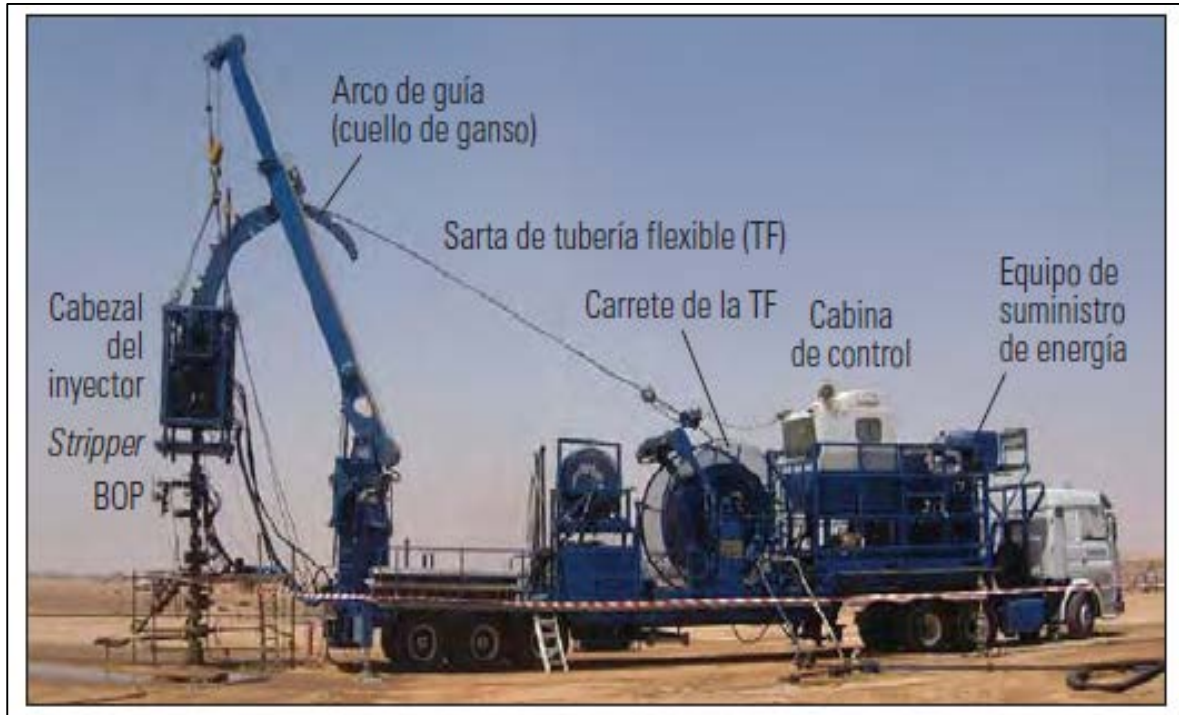
Figura 105. Unidad de tubería flexible o coiled tubing
