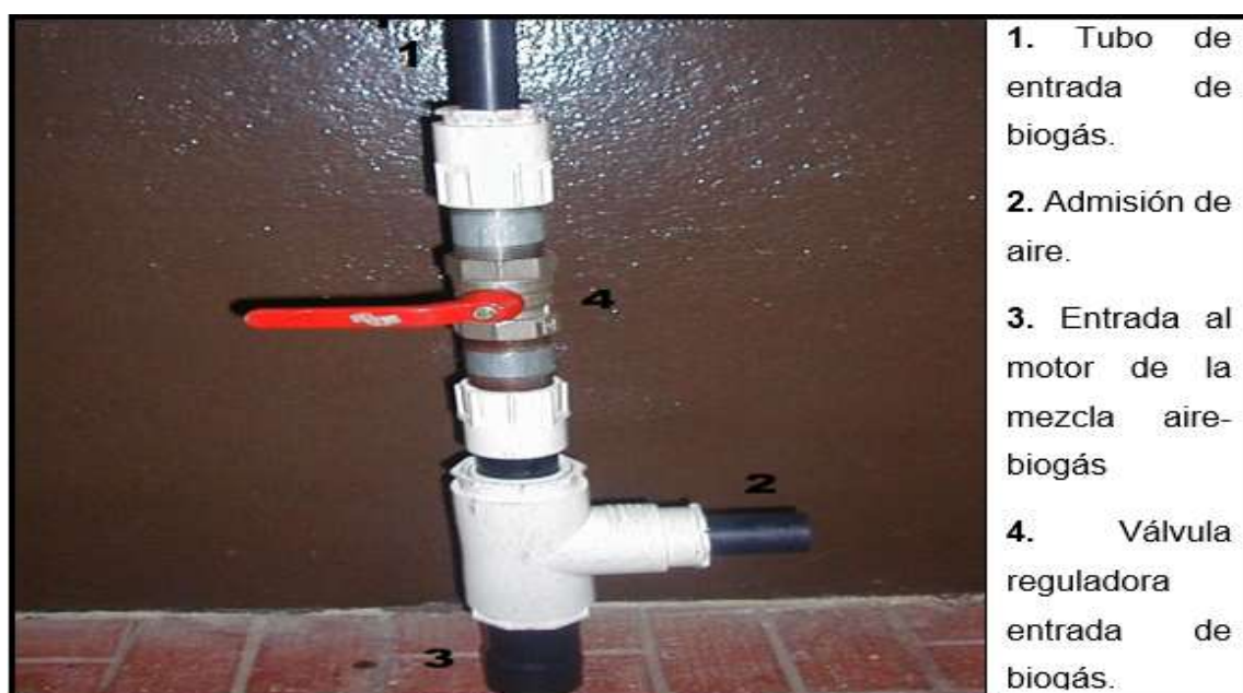
Figura 9. Pieza de adaptación para uso de biogás en motor diésel.
