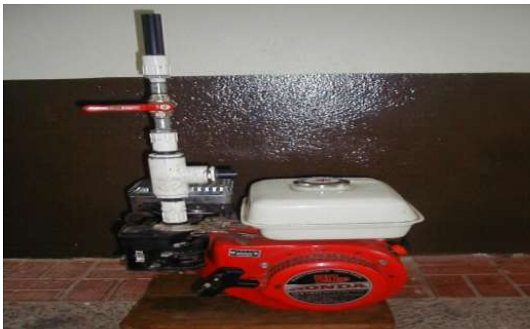
Figura 8. Motor a gasolina de cuatro tiempos con pieza conectada en la posición del purificador de aire.
