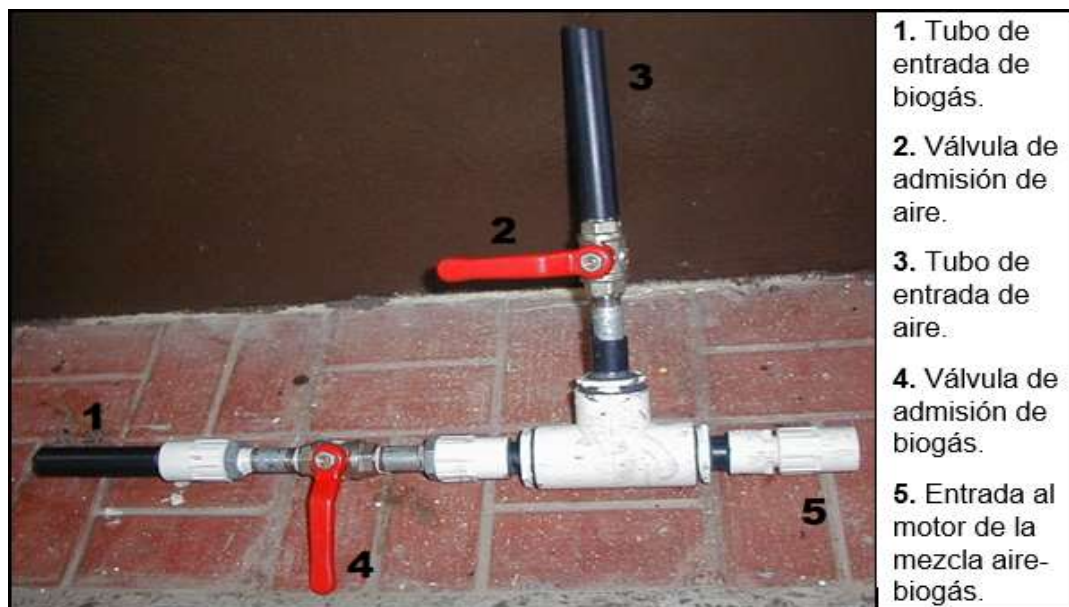
Figura 7. Pieza para adaptar un motor de gasolina al uso de biogás.
