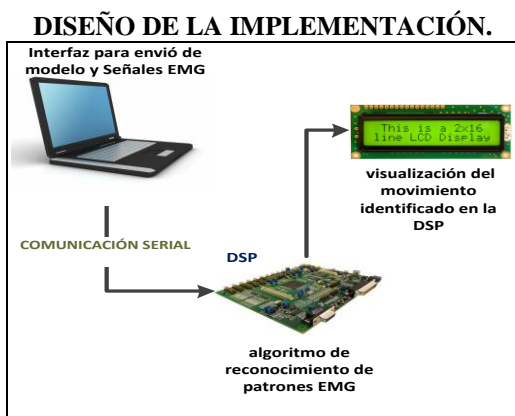
Figura 2. Esquema para el desarrollo de la implementación del algoritmo de reconocimiento de patrones.
