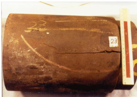
**Figura 7. Picadura por corrosión**
