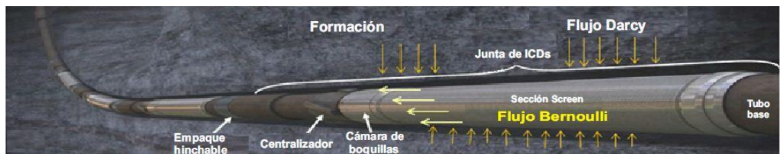
Figura 16. Diagrama básico de la interacción entre el yacimiento y el pozo
