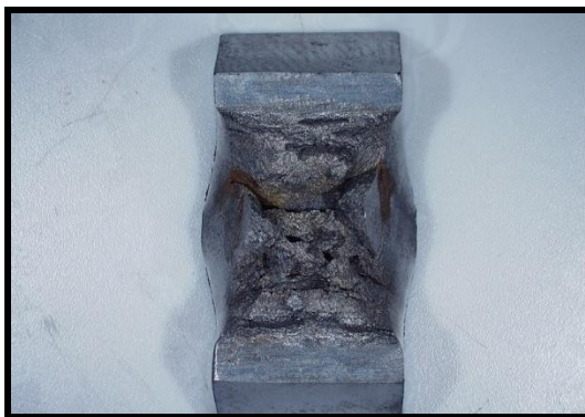
Figura 34. Superficie de fractura bajo condición cero
