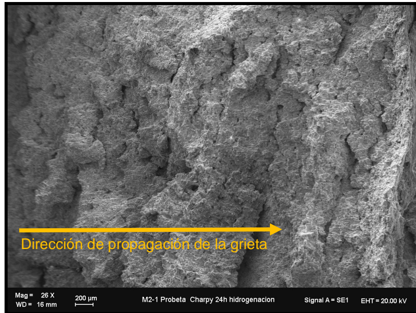
Figura 42. Micrografía (SEM) muestra Charpy luego de 24 horas de hidrogenación
