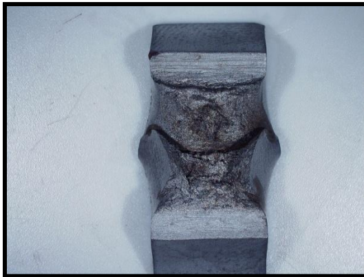
Figura 35. Superficie de fractura bajo 24 horas de hidrogenación
