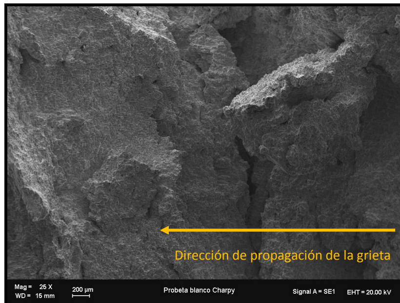
Figura 39. Micrografía (SEM) muestra Charpy en condición cero
