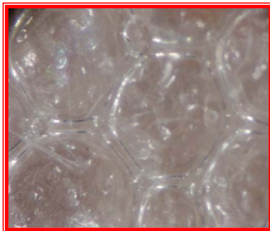
Fotografía 13. Microscopía de la espuma E4 (x 30)
