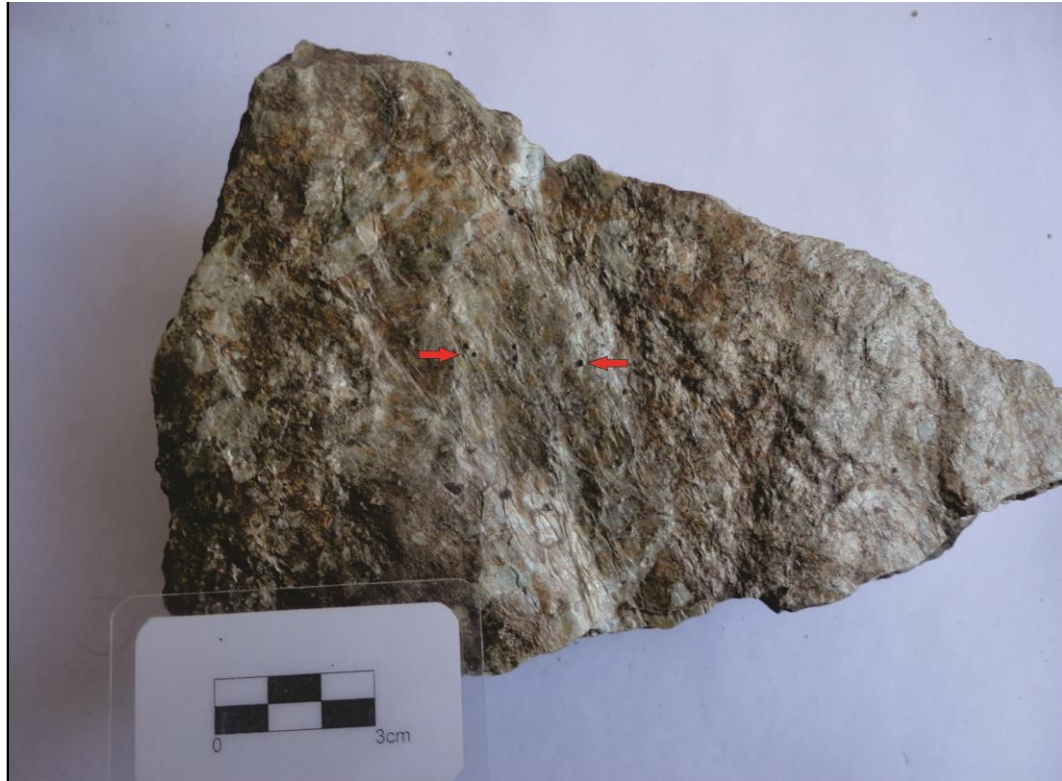
Figura 7. Muestra de mano de esquistos cuarzo-muscovíticos con granate. Se indican los porfidoblastos de granate en la muestra DL 5-1.
