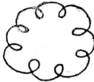
Figura 10. Órbitas de Lissajous para soltura mecánica.
