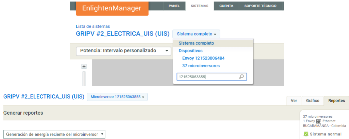
Figura 33. Descarga de datos de potencia en Enlighten.
