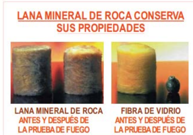
Figura 67. Comportamiento contra el fuego de la lana de roca
