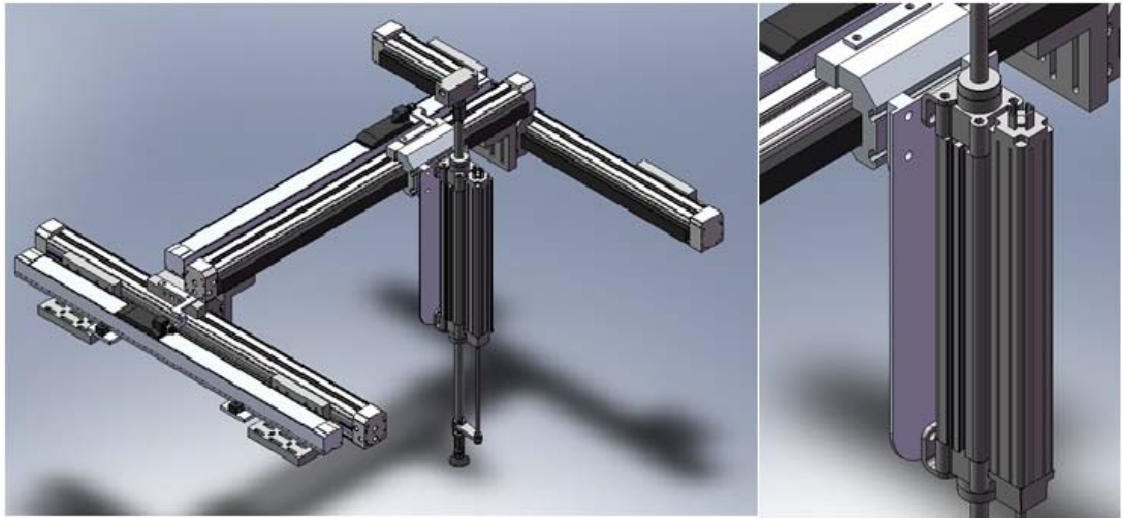
Figura 13. Ensamble de sistema cartesiano por medio de pies
