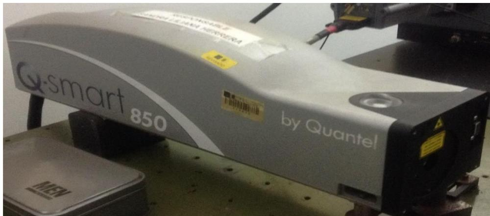
*Nota.* Láser pulsado Nd: YAG (Q-smart (850 mJ) de 1064 nm).
