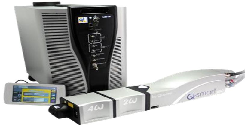
*Nota.* El Q-smart 850 es el nuevo láser Nd:YAG pulsado de Quantel. Controlado por la almohadilla Q-Touch, es un sistema láser de alta energía y rentable.
