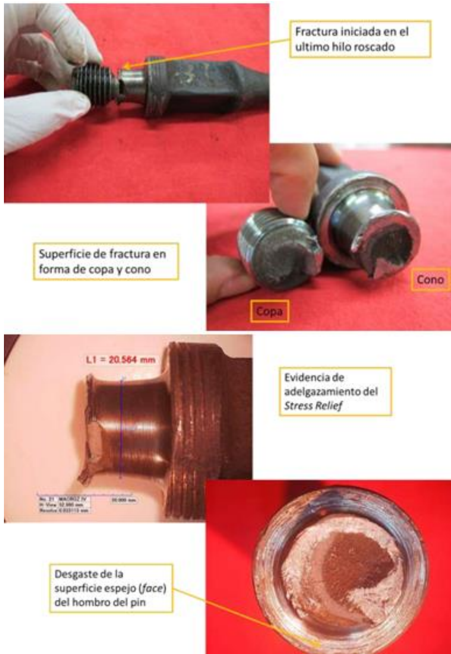
Figura 24. Análisis de falla de varilla partida para el pozo 1.
