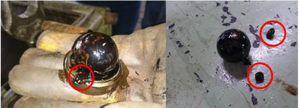
Figura 33. Restos de centralizadores encontrados en las válvulas del pozo 4.
