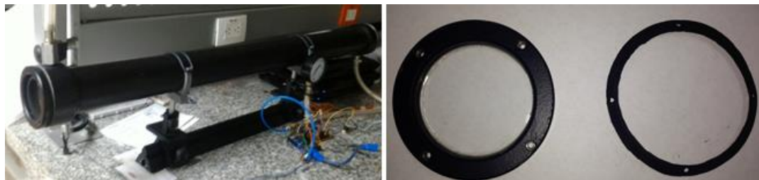
Figura 21. a) Turbulador. b) Brida con vidrio y empaque neumático.
