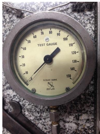
Figura 76. Manómetro calibrado utilizado para la calibración del sensor de presión
