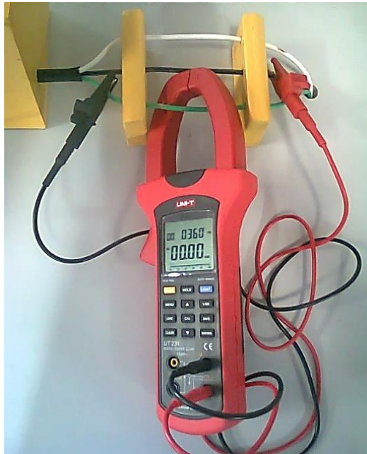
Figura 18. Montaje para medición de potencia.
