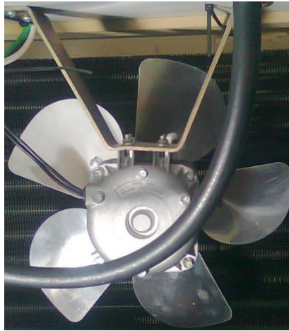
Figura 22. Ventilador del sistema de interenfriamiento.
