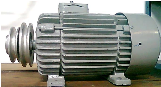
Figura 11. Motor de 3 HP trifásico.
