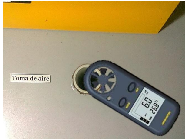
Figura 16. Montaje para la medición de velocidad del aire con el anemómetro.
