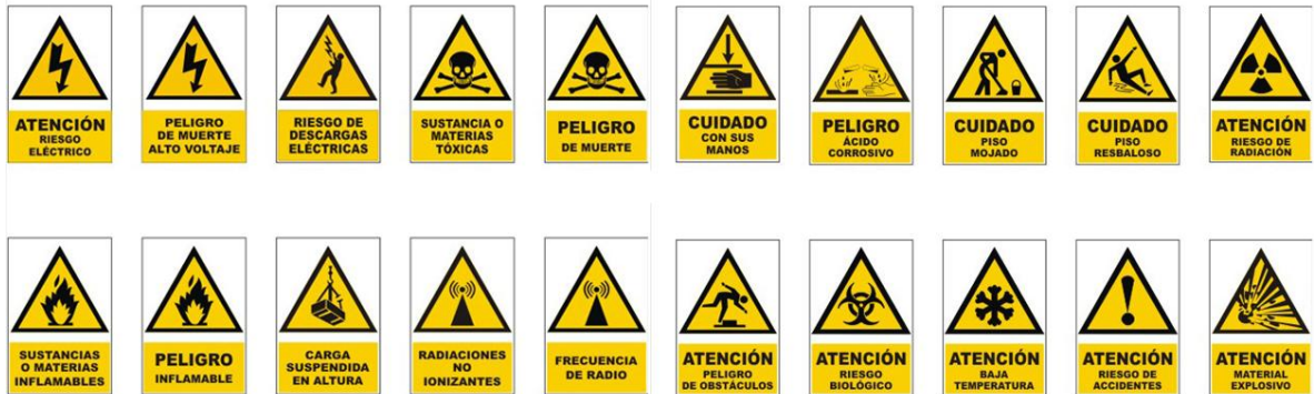
Figura 9. Señales de advertencia
