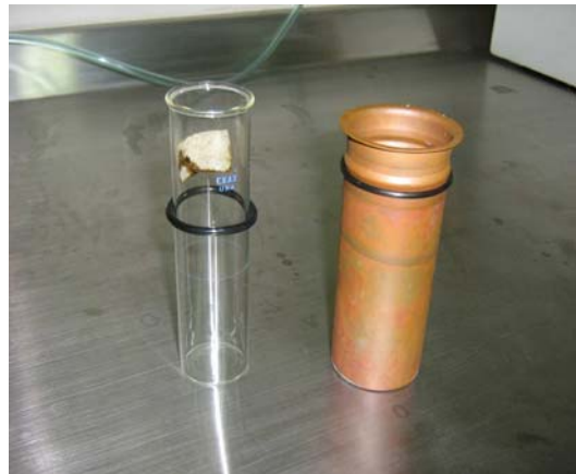
Figura 6. Equipo Laboratorio para la determinación del punto de fluidez
