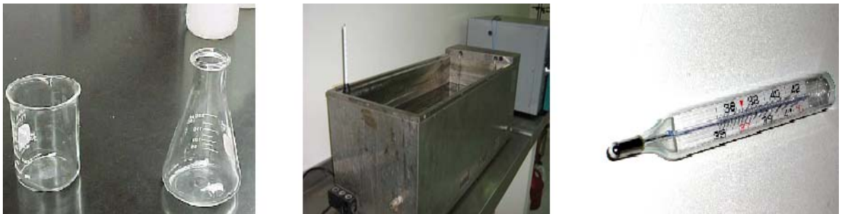
Figura 3. Recipiente, baño térmico y termómetro para determinar el punto de nube
