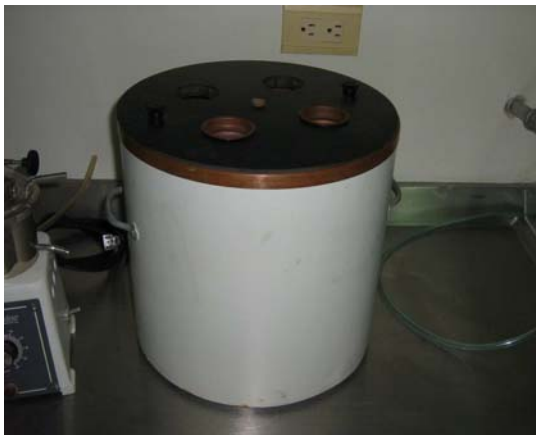
Figura 6. Equipo Laboratorio para la determinación del punto de fluidez
