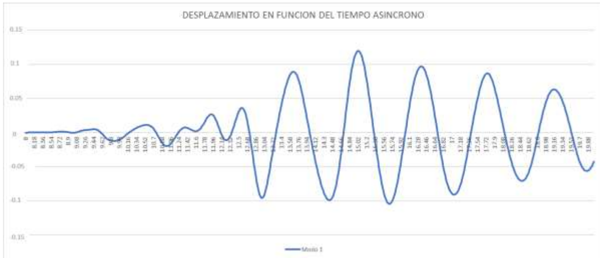
Figura 10. Desplazamientos a lo largo del tiempo en análisis Asíncrono, idealización de cuatro masas.
