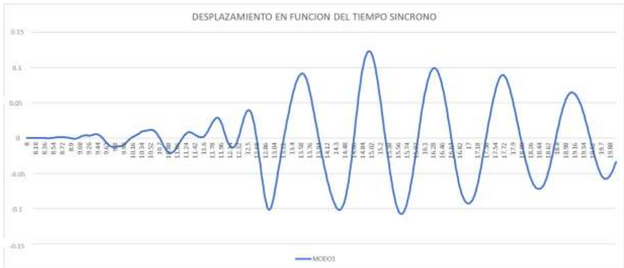
Figura 7. Desplazamientos a lo largo del tiempo en análisis uniforme, idealización de cuatro masas.
