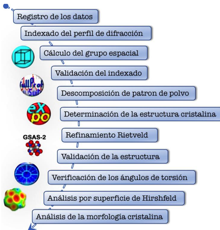
Figura 17. Resolución estructural del hiclato de doxiciclina
