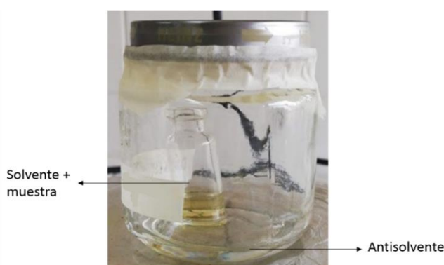
Figura 21. Montaje utilizado para la cristalización por difusión de vapor
