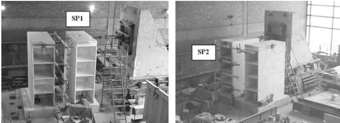
Figura 22. Modelos a escala. SP1, cargado por el eje débil y SP2, cargado por el eje fuerte
