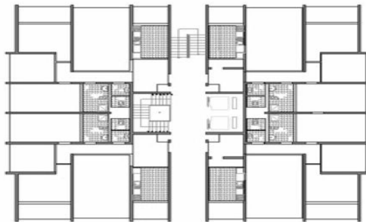
Figura 2 Típica planta simétrico tipo túnel
