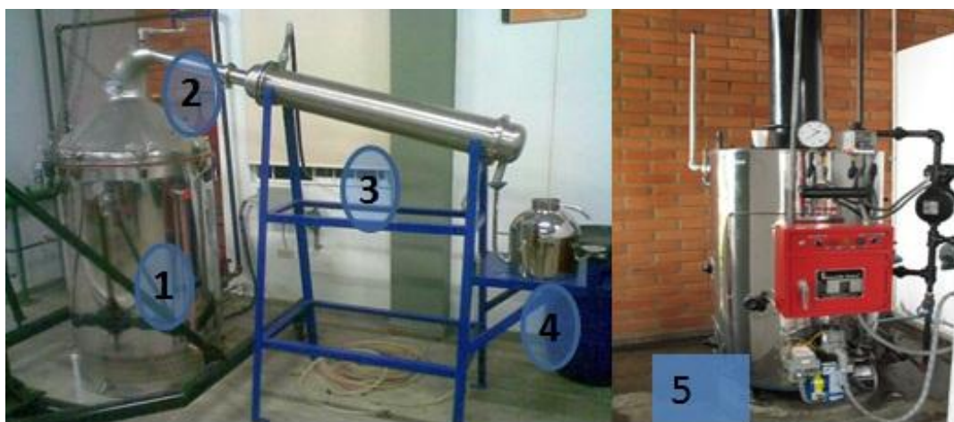
Destilador multimodal (hidrodestilación, arrastre con vapor). 1. Reservorio para el material vegetal, 2. Cuello de cisne, 3. Condensador, 4. Florentino. 5. Caldera para generación de vapor.
