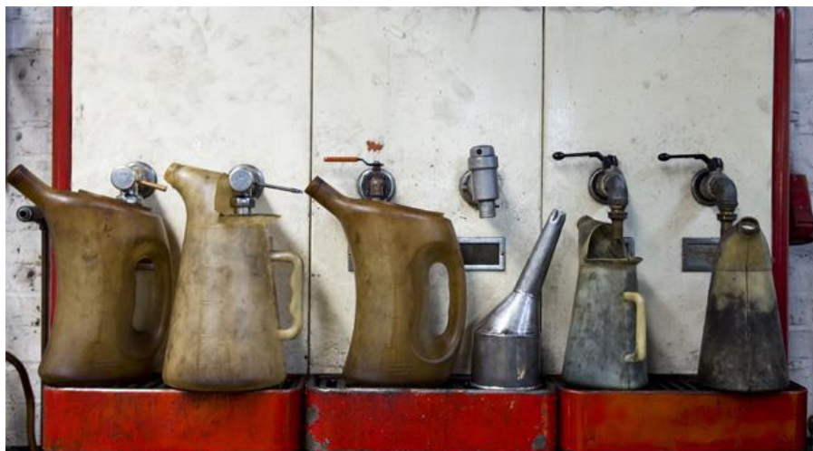
Figura 3. Mal actor para el suministro de Aceite
