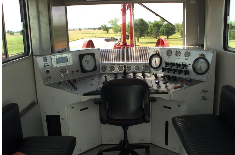
Figura 24. Consola de control del operador
