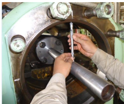
Figura 100. Medición del centrado del patín auxiliar
