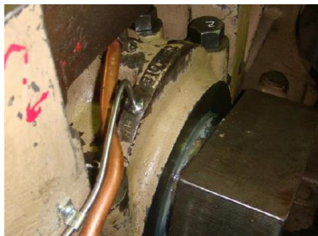
Figura 112. Líneas de lubricación de la bancada.
