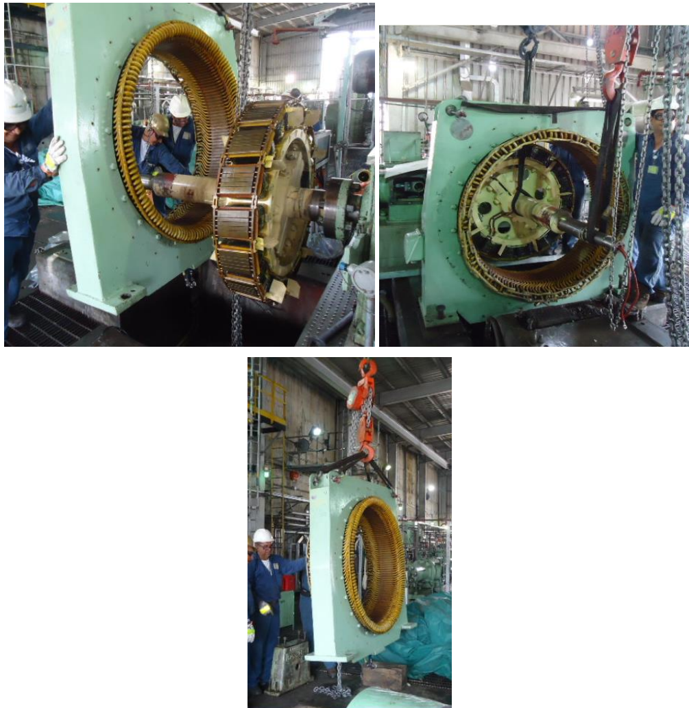
Figura 22. Desmontaje del estator
