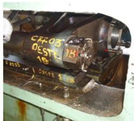
Figura 75. Herramienta para la instalación del yugo del patín auxiliar
