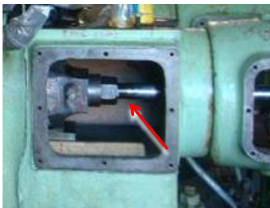
Figura 3. Zona de medición de run out del vástago del pistón.
