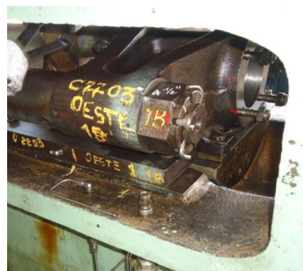
Figura 104. Herramienta para la extracción del yugo del patín auxiliar
