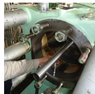
Figura 100. Medición del centrado del patín auxiliar
