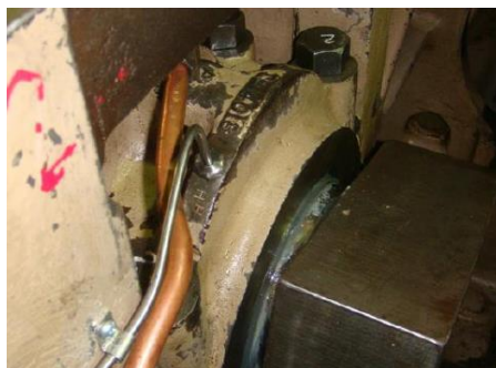
Figura 40. Líneas de lubricación de la bancada.
