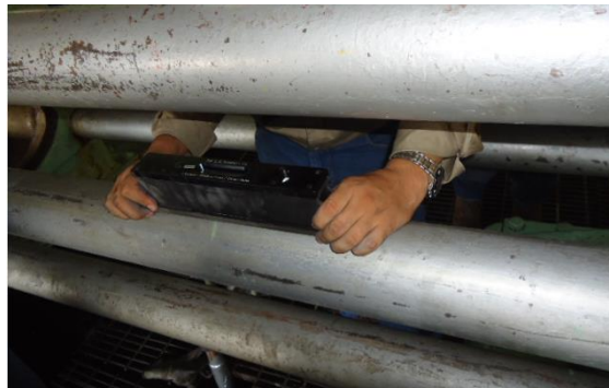
Figura 103. Toma de nivel de barras
