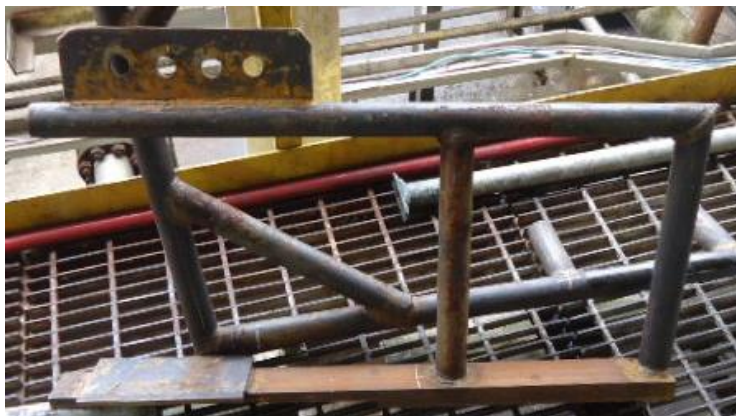
Figura 109. Herramienta para la extracción del cuerpo del patín principal
