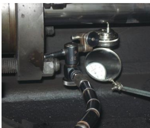
Figura 5. Toma de lectura horizontal del run out del vástago del pistón.
