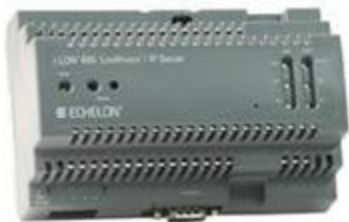
Figura 18. Dispositivo iLon600 LonWorks/IP Server
