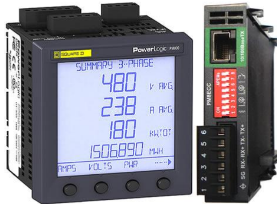
Figura 9. Medidor de energía SquireD PM800
