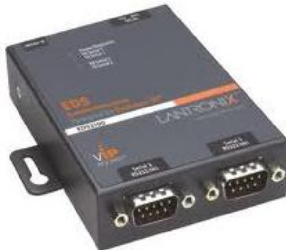
Figura 11. Dispositivo túnel serial-ethernet
