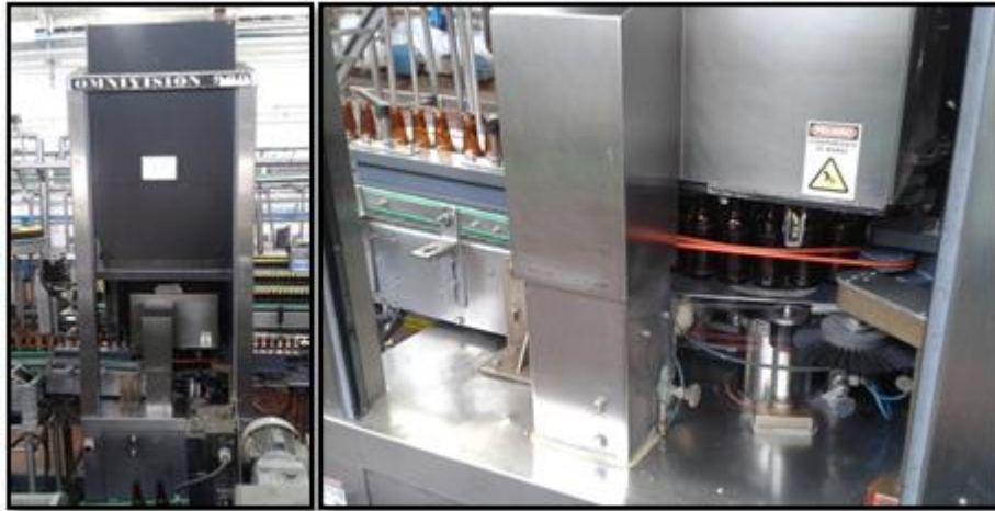
Figura 8. Máquina Inspectora de botella vacía
