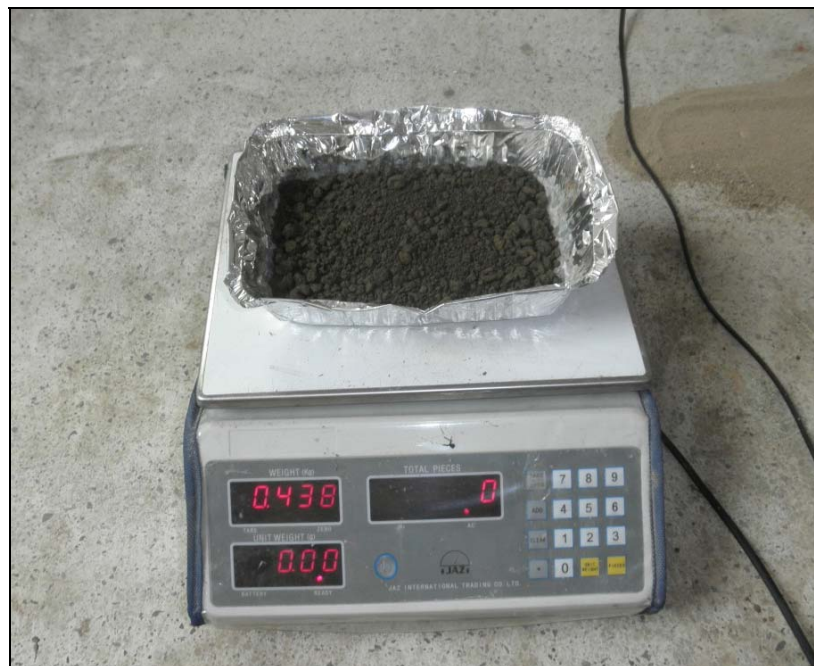
Figura 22. Muestra alterada de suelo para ensayo granulométrico.
