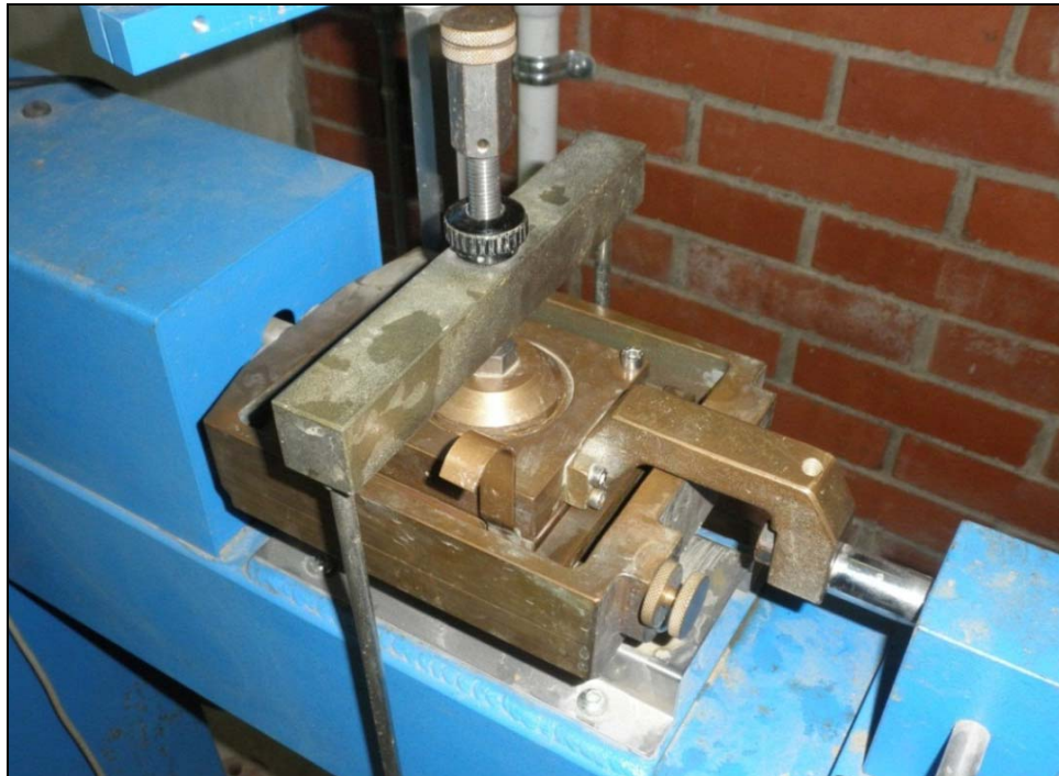
Figura 25. Caja de corte donde se ubica el espécimen de suelo.
