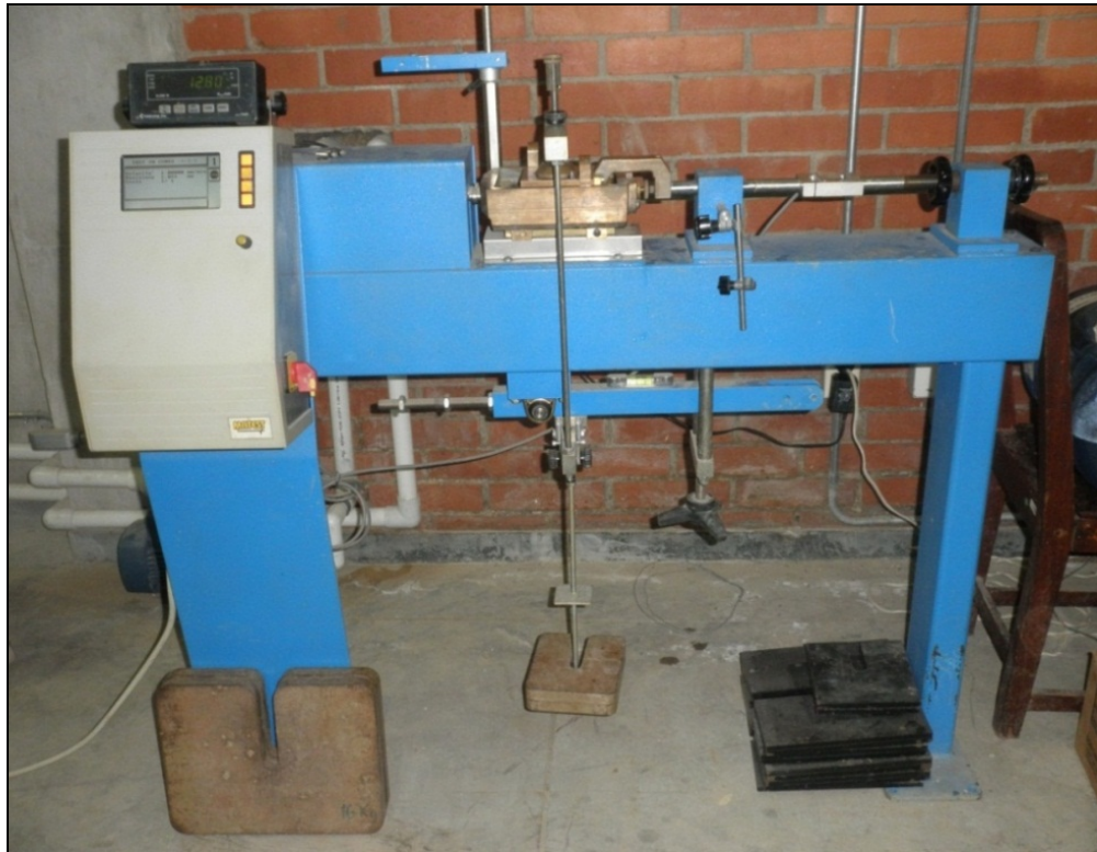
Figura 24. Máquina de Corte Directo.
