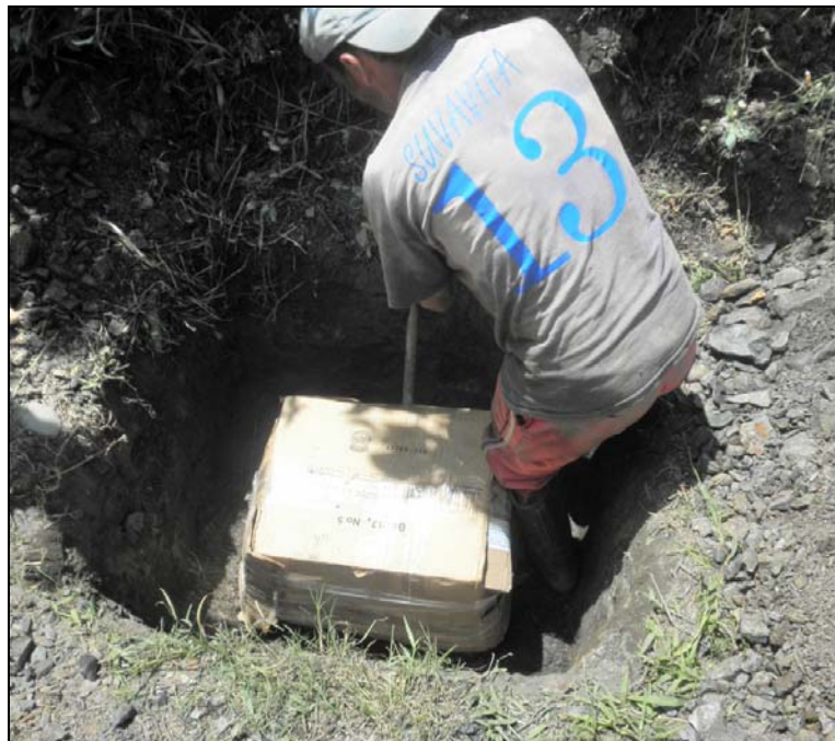
Figura 21. Extracción del monolito de suelo.
