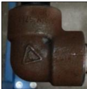
Figura 43. Codo implementado en la línea hidráulica.
