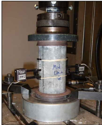
Figura 172. Ensayo a tensión de probetas de hormigón
