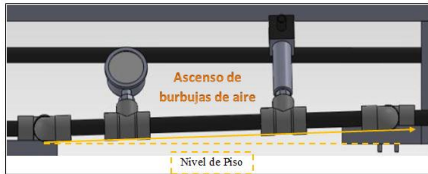
Figura 40. Desnivel en tubería para garantizar la purga del sistema
