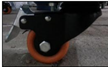
Figura 54. Ruedas del soporte de tubería.
