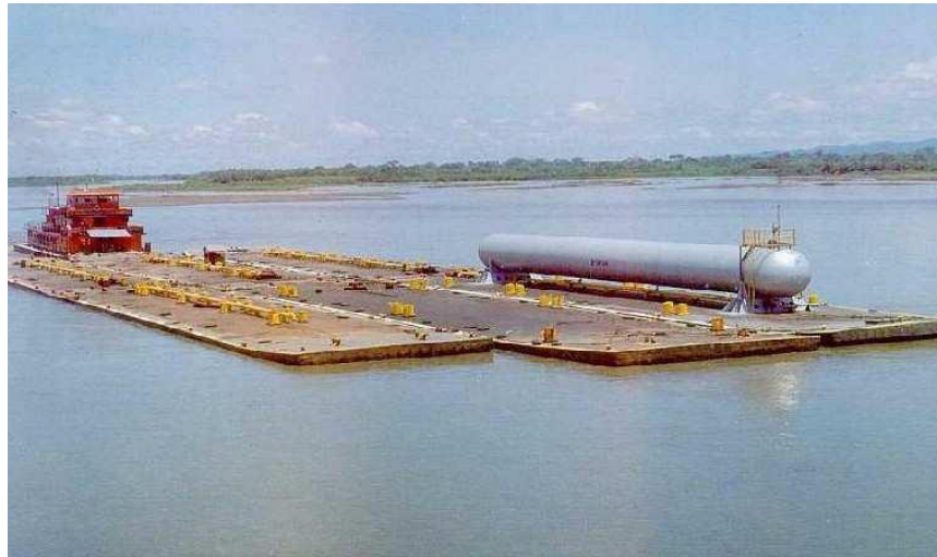
Figura 2. Convoy R-3B-3B – Utilizado para el transporte de crudo e hidrocarburos, líquidos en bodegas y cubiertas
