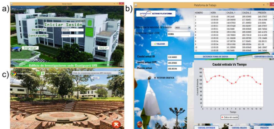
Figura 5. Interfaz Gráfica de Usuario diseñada para el sistema de adquisición de datos conformada por a) Pantalla de inicio de sesión b) Plataforma de trabajo c) interfaz de ayuda.
