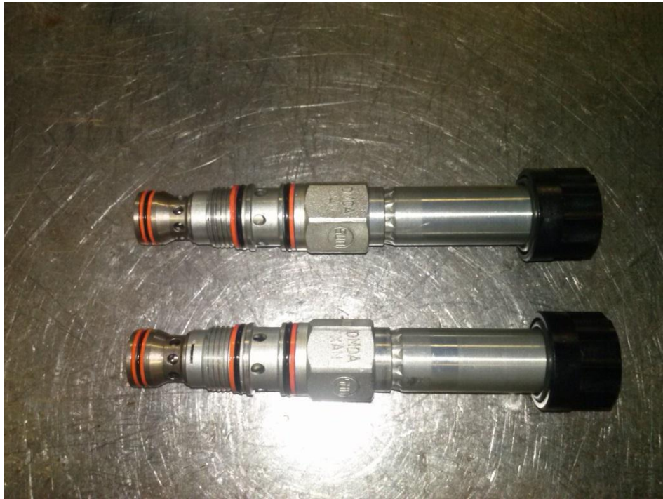
Figura 62: Válvulas direccionales 2x3 normalmente abierta.
