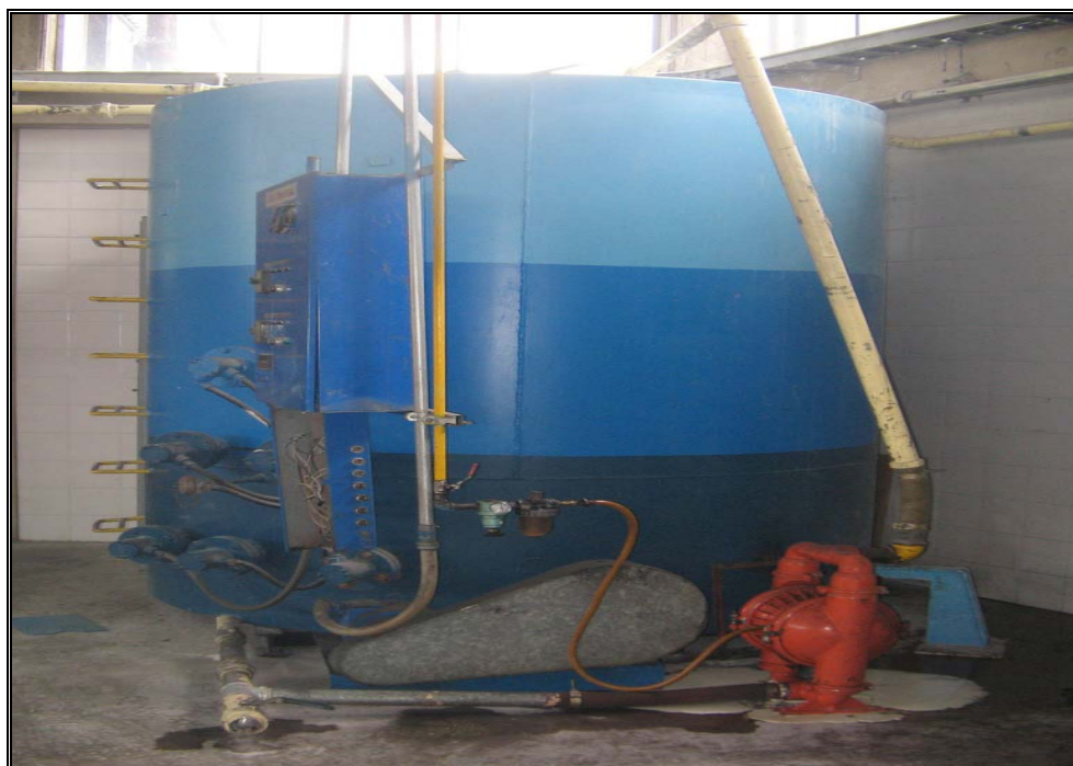
Fotografía N° 3. Tanque primario para la preparación de goma.
