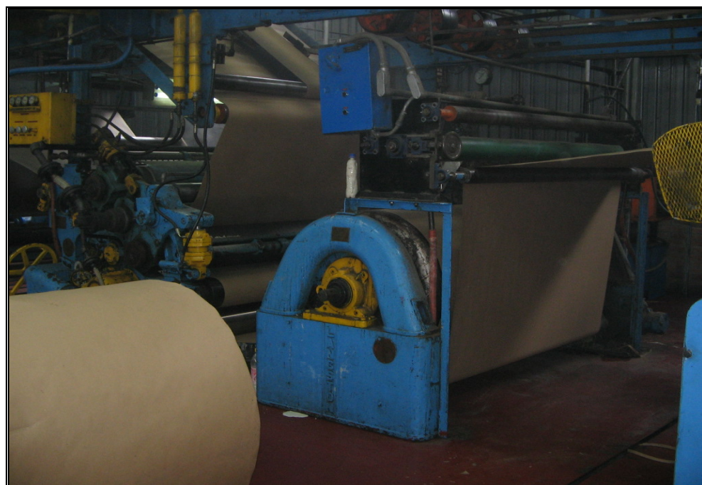
Fotografía N° 12. Unión de los dos papeles, por efecto de presión y calor. (Single Face)
