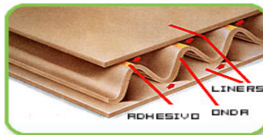
Figura N° 1 Composición de la lámina de papel corrugado
