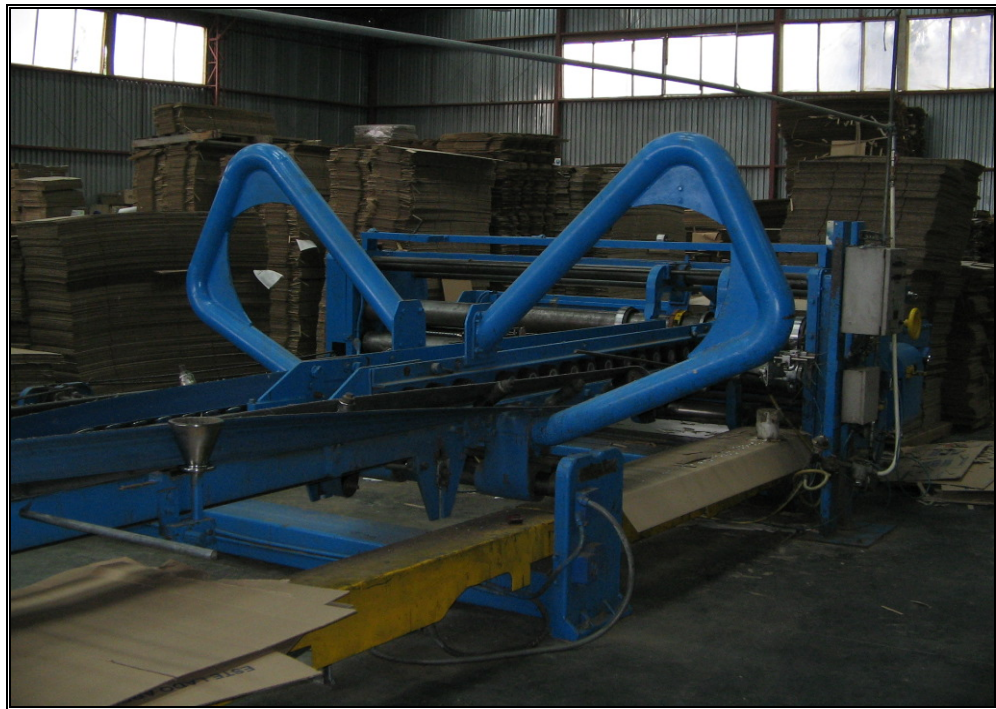
Fotografía N° 34. Proceso de pegue de las aletas.
