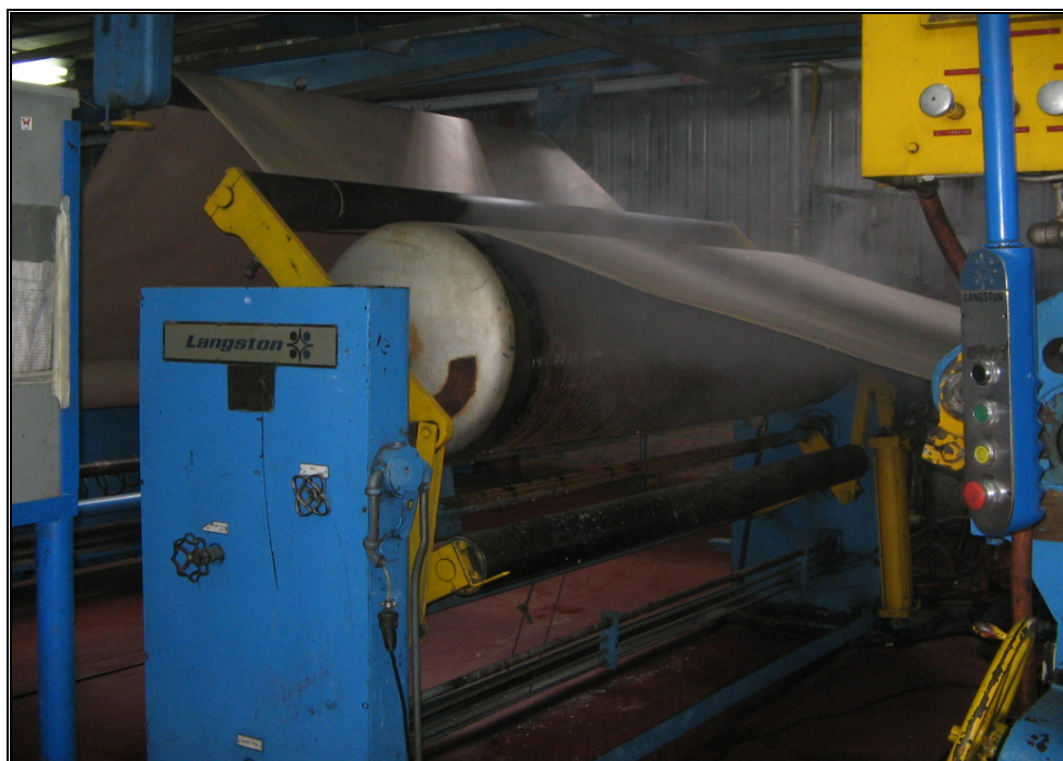
Fotografía N° 8. Ingreso del papel Liner inferior a la máquina.
