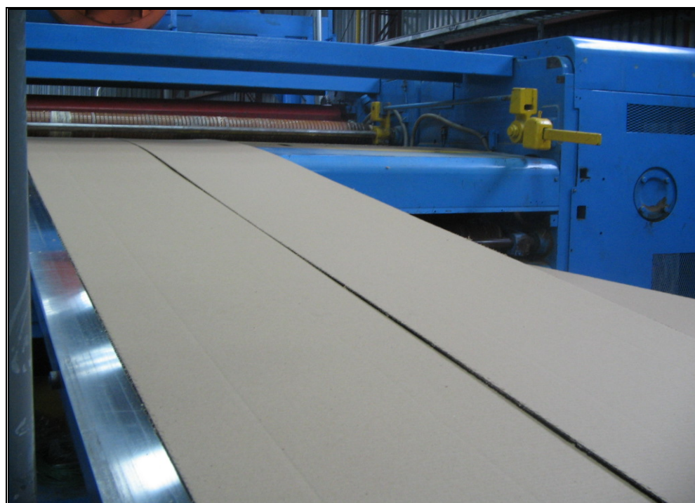
Fotografía N° 24. Corte ancho de la caja.
