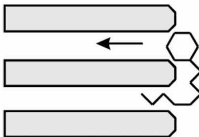
Figura 4. Modelo general del fenómeno de catálisis en la boca del poro involucrado en la reacción de isomerización del 1-ciclohexiloctano.
