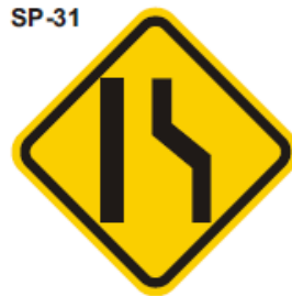
Figura 24. SP-31 Reducción asimétrica de la calzada (derecha)
