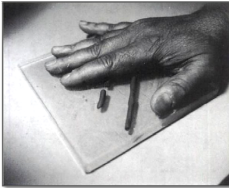
Figura 79. Prueba del límite plástico
