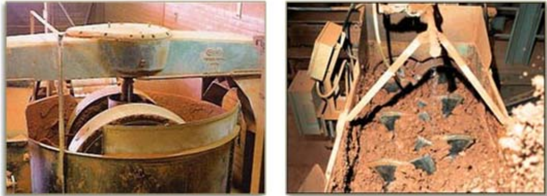
Figura 28. Mezcla y homogenización del material arcilloso
