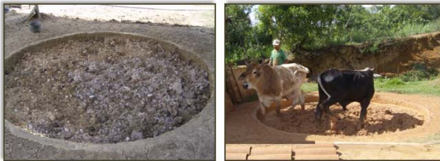
Figura 5. Pilas de preparación de pastas
