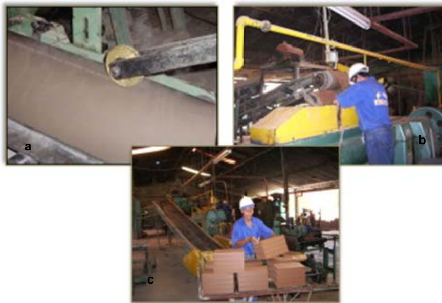
Figura 25. Algunas etapas de producción en Ladrillos y Tubos (B/manga): (a) Corte, (b) Extrusión, (c) Transporte de productos terminados
