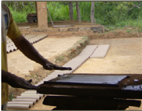
Figura 8. Conformado manual de una teja
