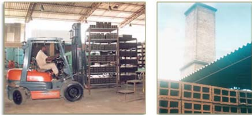
Figura 30. Secado y transporte de las piezas para ser llevadas al horno
