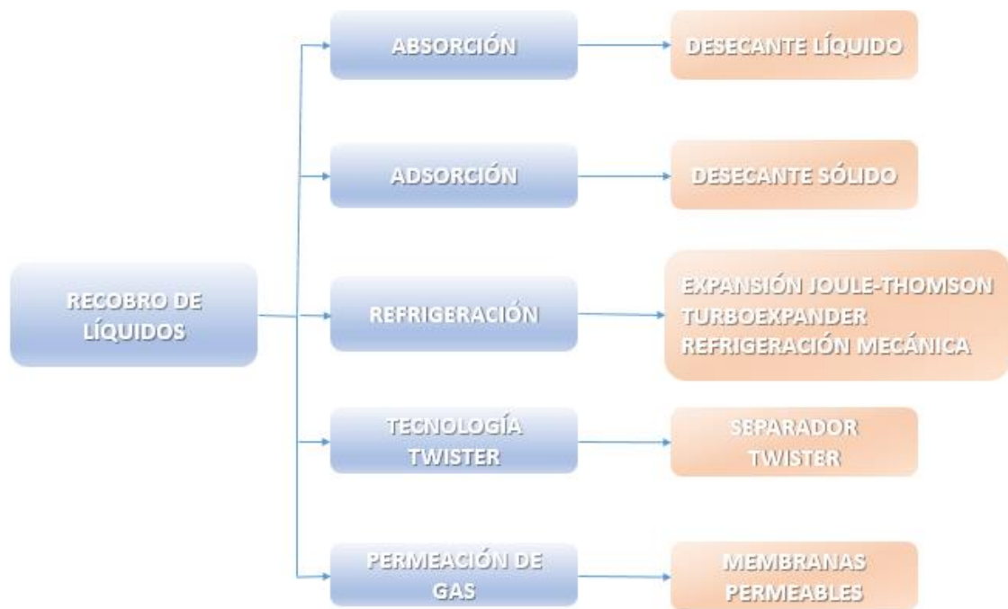
Figura 12. Procesos de recobro de líquidos de gas natural
