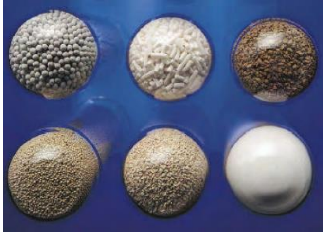
Figura 8. Elementos de adsorción empleados en tamices moleculares
