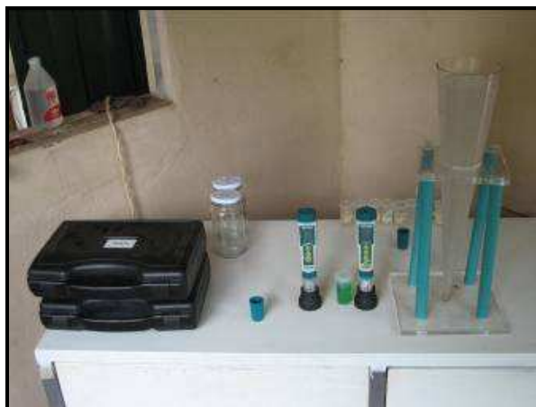
Figura 2. Equipos para la medición de pH, conductividad y sólidos disueltos
