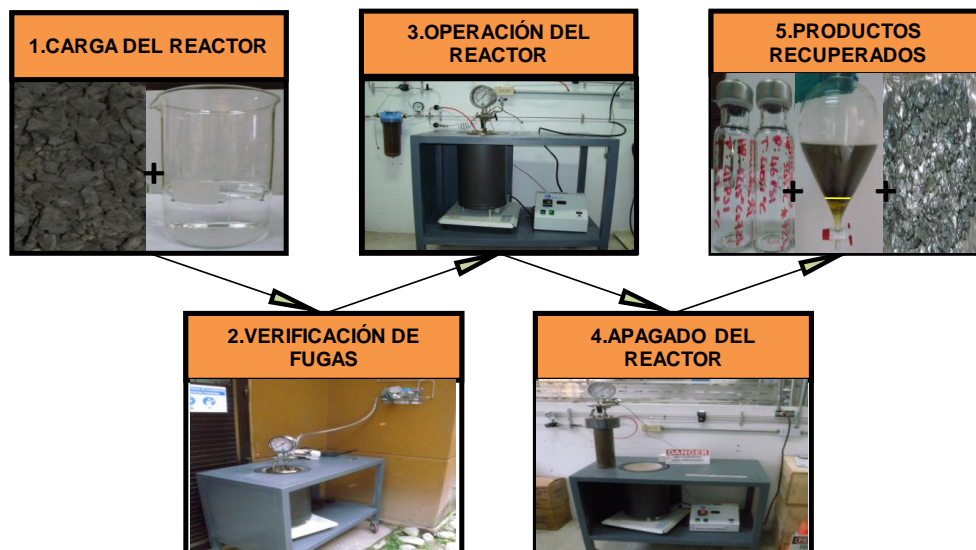
Figura 11: Procedimiento analítico de la generación del petróleo, utilizando el reactor PARR del Laboratorio de Geoquímica Orgánica del Instituto Colombiano del Petróleo (ICP).
