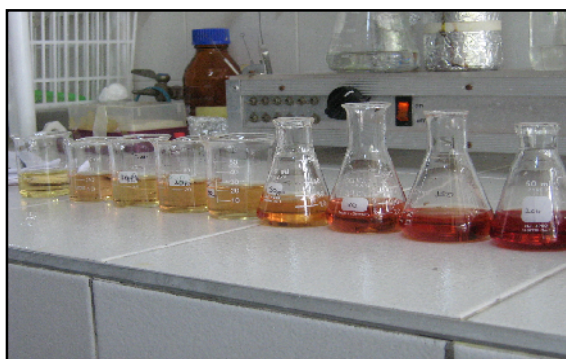
Figura 10. Método colorimétrico para medir el sustrato fenol
