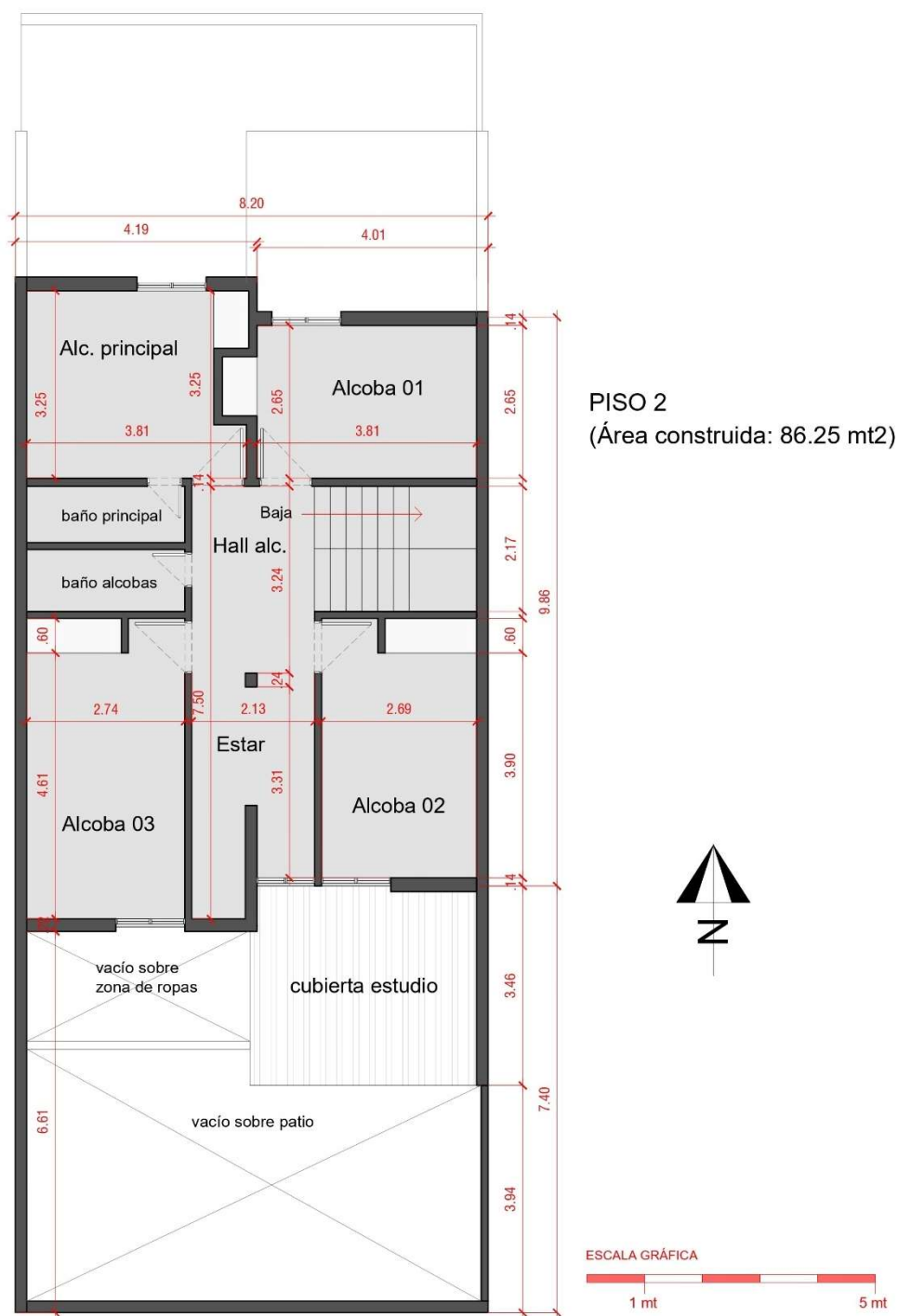
Figura. 150. Planta arquitectónica segundo piso vivienda en el barrio Las Ceibas. Bucaramanga.
