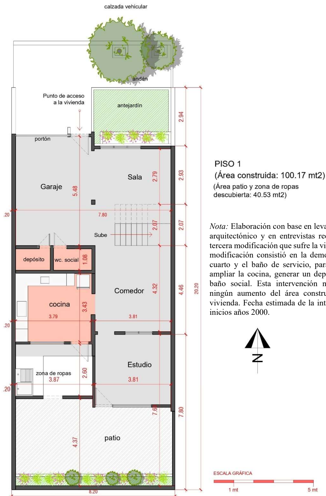
Figura. 149. Planta arquitectónica primer piso vivienda en el barrio Las Ceibas. Bucaramanga. Estado en el año 2000.
