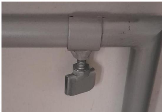
Se deben agregar las agarraderas antes de empezar a soldar las barras que conforman el marco, de otra forma se dificultara el proceso de ensamblaje, dicho marco está formado por tres barras de perfil redondo cortadas de acuerdo con las dimensiones del patrón de plegado, cabe recordar que el patrón de plegado está construido de forma que se puedan agregar más módulos dependiendo de las características del edificio en que se va a instalar el dispositivo.
