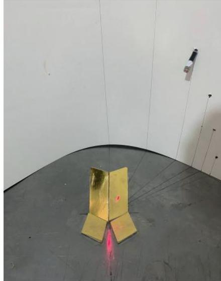
*Nota.* La imagen presenta el módulo abierto en el ángulo necesario para redirigir la luz del puntero laser hacia la cámara.
