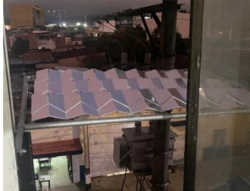
La medición fue tomada con un luxómetro electrónico, primero se midió el nivel de lumen en la habitación, colocando el dispositivo en la posición de plegado más conveniente de acuerdo con las condiciones climáticas, la hora del día y la posición del edificio donde se hace la verificación, una vez obtenida la medida se cierra el dispositivo y se vuelve a tomar otra medición en ese instante con el fin de mantener constancia en las condiciones lumínicas.
