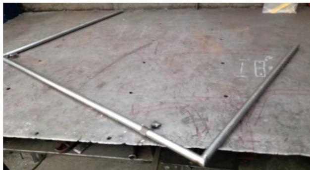
Luego se debe soldar la barra móvil, que consta de una barra de perfil redondo soldada a dos secciones de tubo metálico lo suficientemente grande para poder deslizarse sobre la barra metálica que se usó para soldar el marco de la estructura
