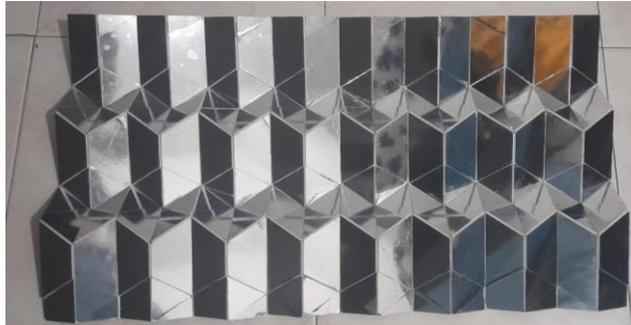
Luego de unir los módulos para formar las filas, se procede a unir las filas hasta conseguir las dimensiones totales de la estructura que dependen de las medidas de la ventana, esta estructura consta de la unión de 8 filas y se sigue el mismo procedimiento que se describió para la unión de módulos.
