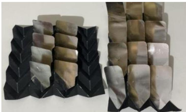
Respecto la alternativa 1, añadir material en una de las caras del dispositivo para solucionar el problema de los rayos de luz atrapados no es suficiente, si bien se debe aumentar la superficie reflectiva, agregar material sin integrarlo al patrón crea un problema causado por el espesor del material ya que el material extralimita su capacidad de colapsarse y a la vez aumenta el peso del dispositivo.
