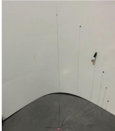
La altura a la que se posicionó la fuente de luz se obtuvo utilizando trigonometría, se toma el ángulo de elevación junto con la distancia marcada desde el punto central a la base de la pared formada con la cartulina.
