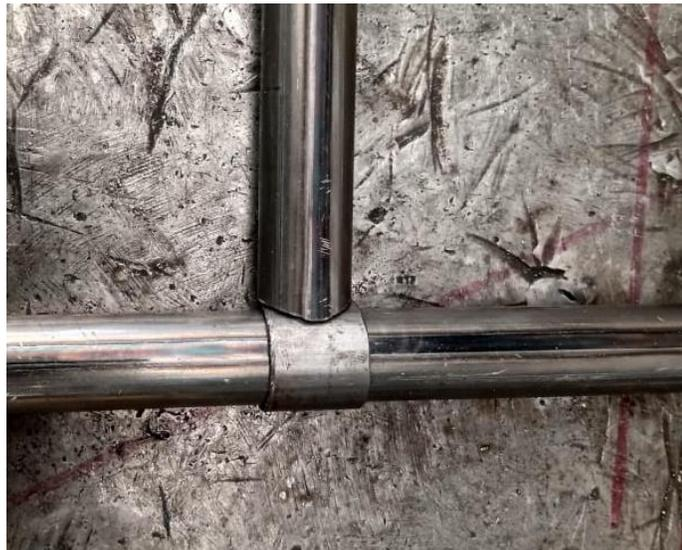
En este punto se debe ensamblar el patrón de plegado extendiéndose completamente y ajustando las agarraderas de tal forma que el patrón quede fijo dentro de estas.
