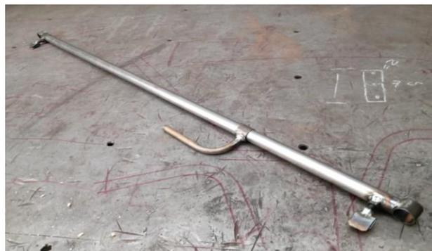
Al igual que con el marco, las agarraderas y la manija se deben colocar sobre la barra móvil antes de soldar las secciones de tubo metálico que se ensamblan a los laterales del marco.
