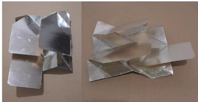
*Nota.* Prototipo de bajo nivel fabricado en material semi rígido forrado de material reflectivo.
