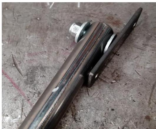
*Nota.* Sistema de sujeción para instalación del marco metálico del dispositivo a la fachada de la vivienda.
