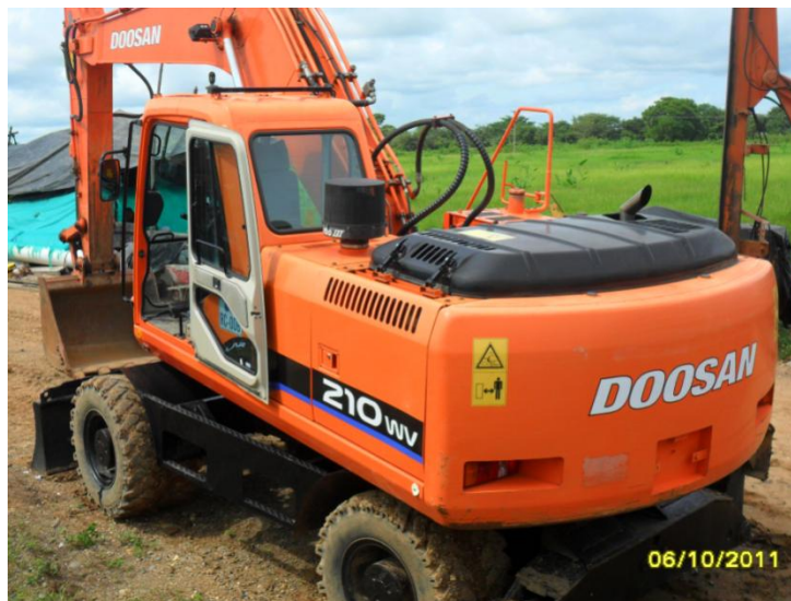
Figura 2. Excavadora sobre llantas marca DOOSAN.
